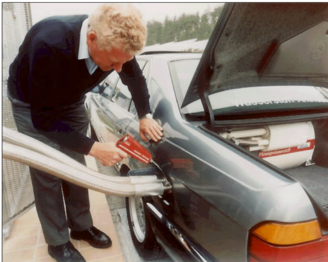
Abb. 5: Helium-Lecktest nach Anschluß der Johnston-Cox-Kupplung
